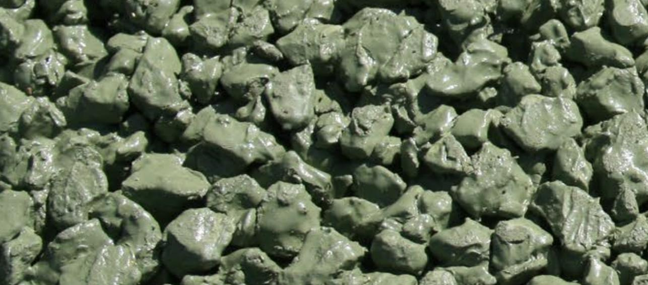
*Beton posebne strukture s kontroliranom propusnošću.*
